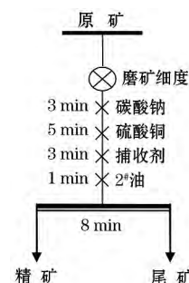
图 1 硫化矿浮选条件试验流程
